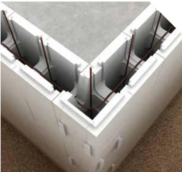
Mise en place de l'armature verticale.
