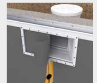
Étanchéité au droit du skimmer.
