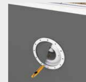
Étanchéité au droit du projecteur.
