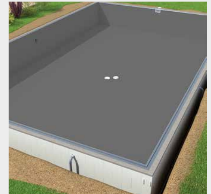
Mise en place du liner.
