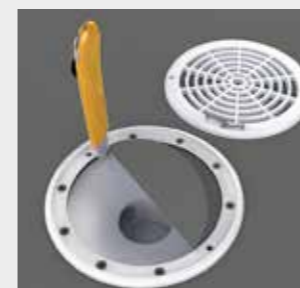
Étanchéité de la bonde.
