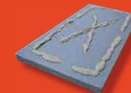
\*Un calage en plein peut être envisagé sur support présentant une planéité suffisante à savoir 5 mm maximum sous la règle de 2 m, en laissant libre une bande de 2 cm de largeur en périphérie de panneau, afin d'éviter la pénétration de la colle dans les joints.
