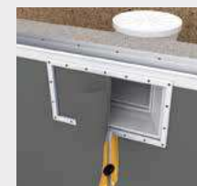
Étanchéité au droit du skimmer.
